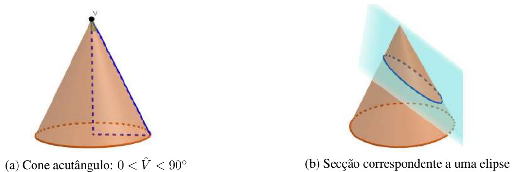
Figura 6: Como se obtinha a elipse
