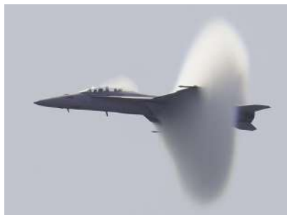
Figura 86: Avião supersônico e o cone de Mach
