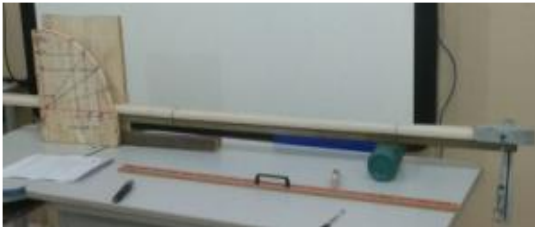
Figura 5 – Plano inclinado construído usado em sala de aula.
