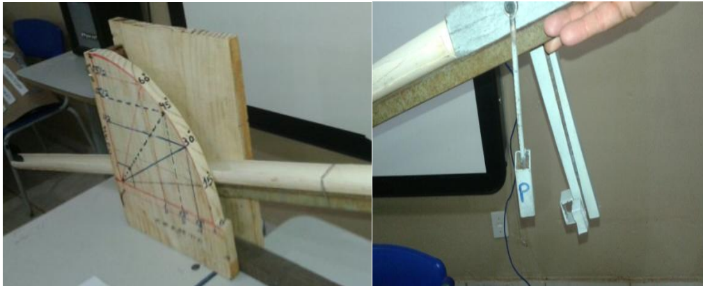
Figura 4 – Plano inclinado construído usado em sala de aula.
