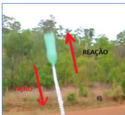
Figura 3.2 – garrafa pet sendo lançada – princípio da ação e reação Fonte: Dados do Autor
