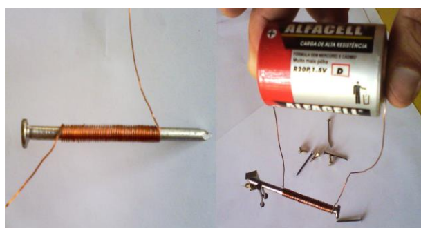
Figura 2.10 - Demonstração experimento eletroímã Fonte: Dados do Autor
