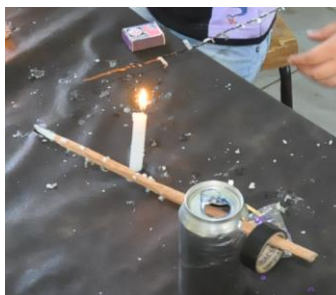
Figura 3.6 - Demonstração condução térmica Fonte: Dados do Autor
