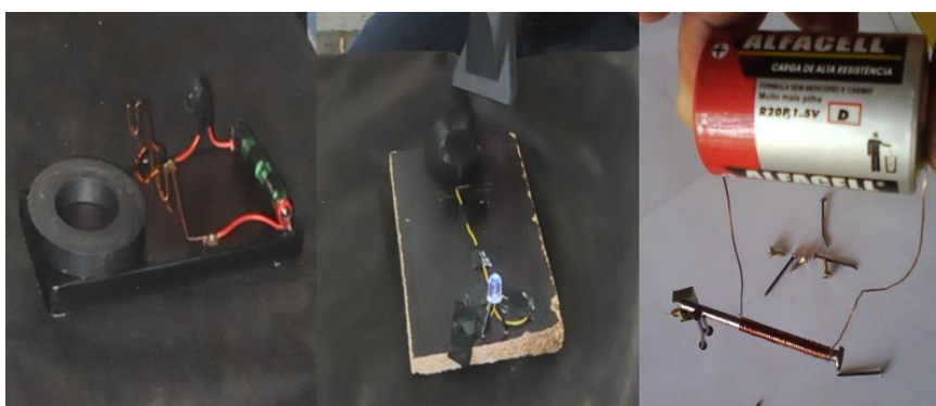
Figura 3.8 - Motor Elétrico, Geração Energia Eólica e Eletroímã. Fonte: Dados do Autor
