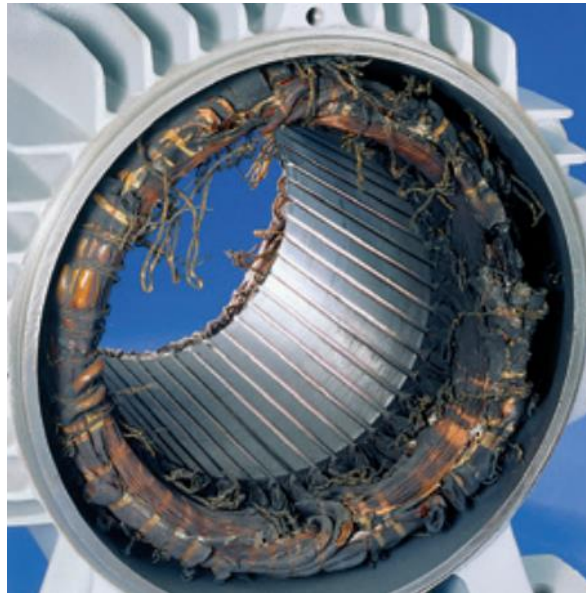
Figura 7 - Enrolamentos expostos a sobreaquecimento.
