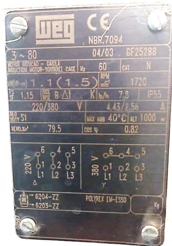
Figura 6 - Placa de identificação de um motor de indução trifásico.
