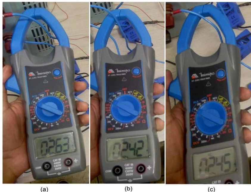
Figura 47 – Medição das correntes nas fases no motor com o rotor bloqueado: (a) Corrente na fase a; (b) Corrente na fase b e (c) Corrente na fase c.
