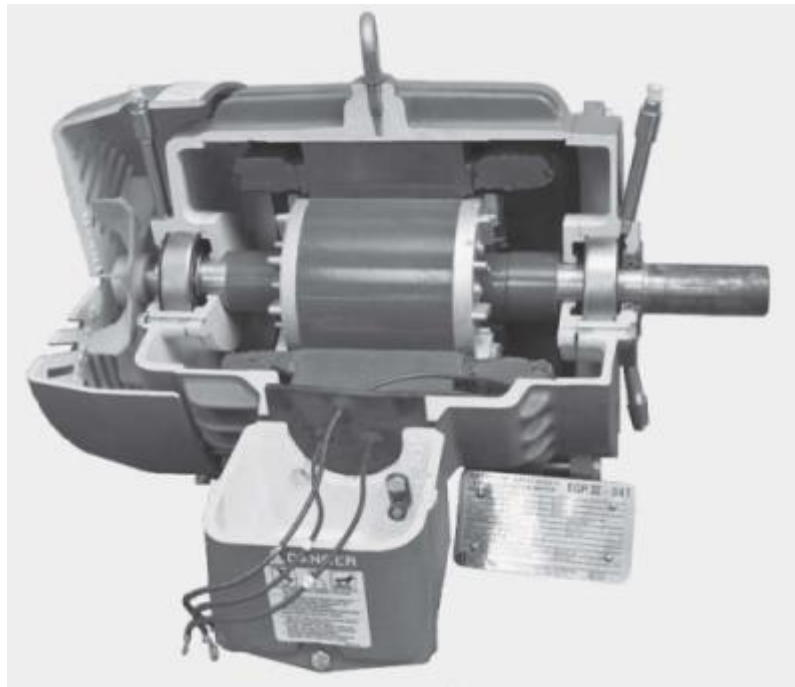
Figura 2 – Vista em corte longitudinal de um motor de indução com rotor gaiola de esquilo.
