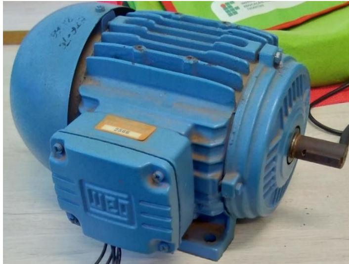
Figura 38 - Motor de indução trifásico
