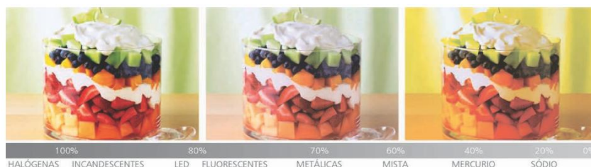
Figura 3.2 – Índice de Reprodução de Cor das lâmpadas halógenas, incandescentes, LEDs, fluorescentes, metálicas, mista, mercúrio e sódio.
