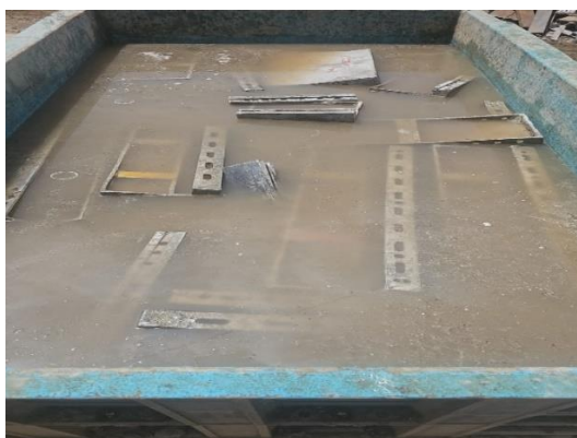
Figura 50 – Banho químico para limpeza da fôrma.
