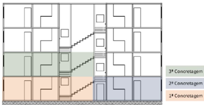
Figura 38 – Metodologia de montagem de fôrmas.
