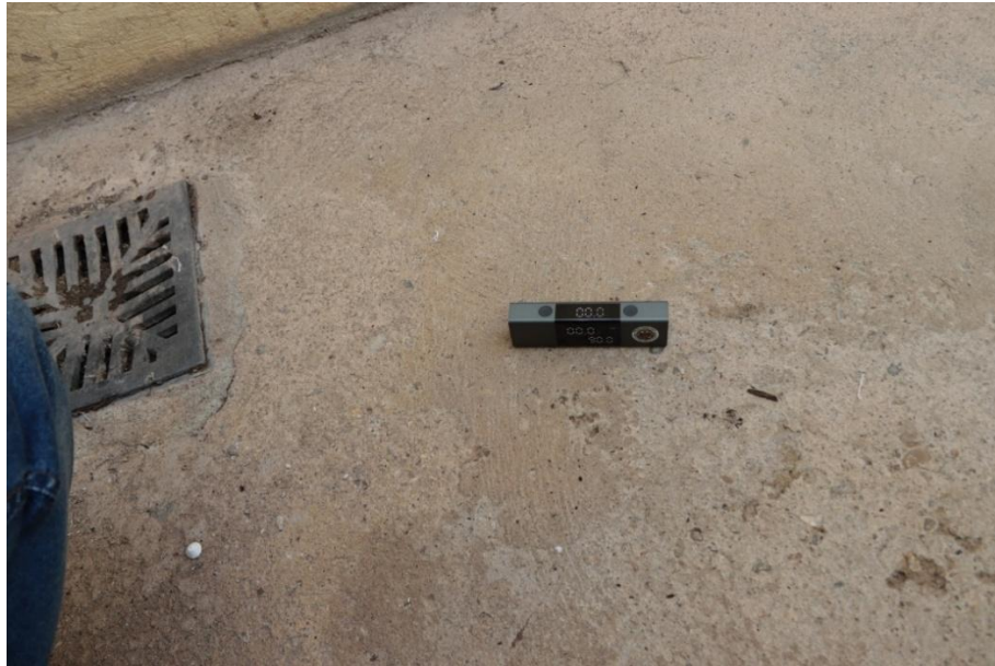
Figura 52 – Inclinômetro digital registrando 0.0° na área de serviço
