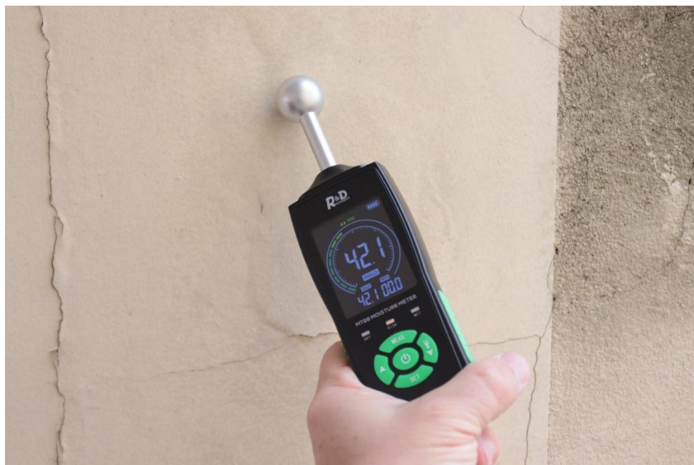
Figura 42 – Medidor de umidade registrando 42,1%
