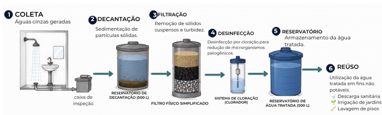
Figura 1 – Fluxograma do sistema simplificado de tratamento e reúso de águas cinzas adotado no estudo.
