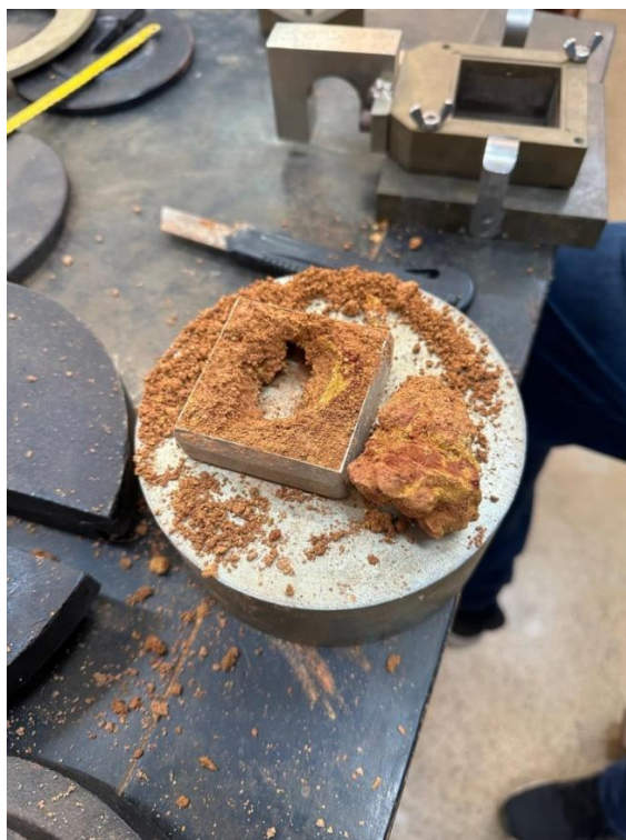
Figura 35 – Pedregulho na hora da moldagem do corpo de prova
