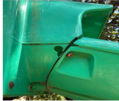
Quebra do escorregador
