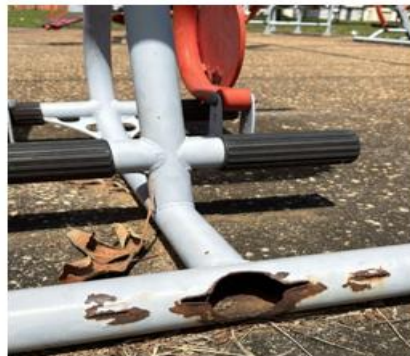
Quebra de elemento estrutural
