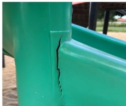
Trinca no escorregador
