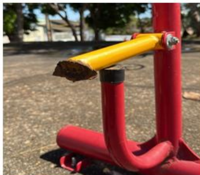
Quebra de peça e aresta cortante
