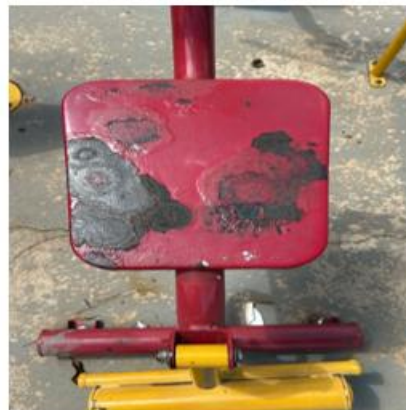
Corrosão de assento
