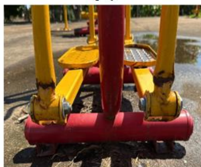
Corrosão de peça deformada
