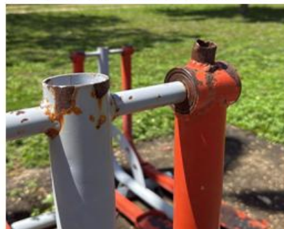
Quebra de elemento de apoio
