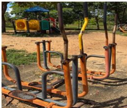
Corrosão de equipamento
