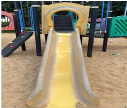
Desbotamento em escorregador
