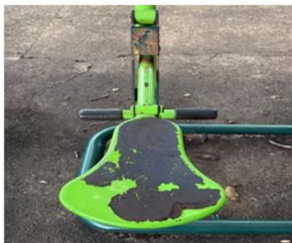
Corrosão em assento
