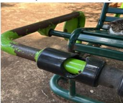
Deformação de elemento de apoio
