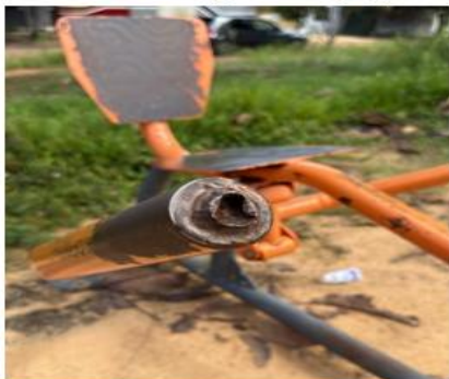
Corrosão e quebra da peça
