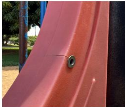
Fissura na região da ligação
