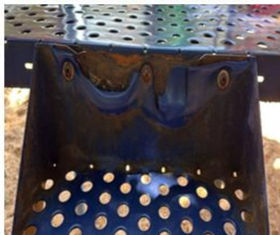
Deformação no revestimento
