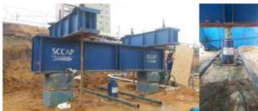
Figura 2 – Montagem do sistema de reação, aplicação de carga e medição dos deslocamentos.
