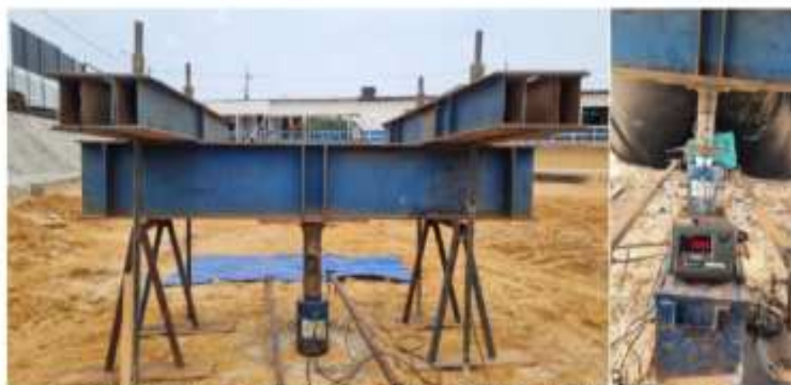
Figura 2 - Montagem do sistema de reação, aplicação de carga e medição dos deslocamentos.
