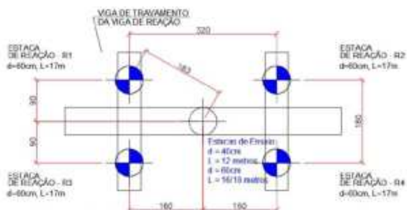
Figura 1 – Desenho esquemático da configuração de montagem dos ensaios.
