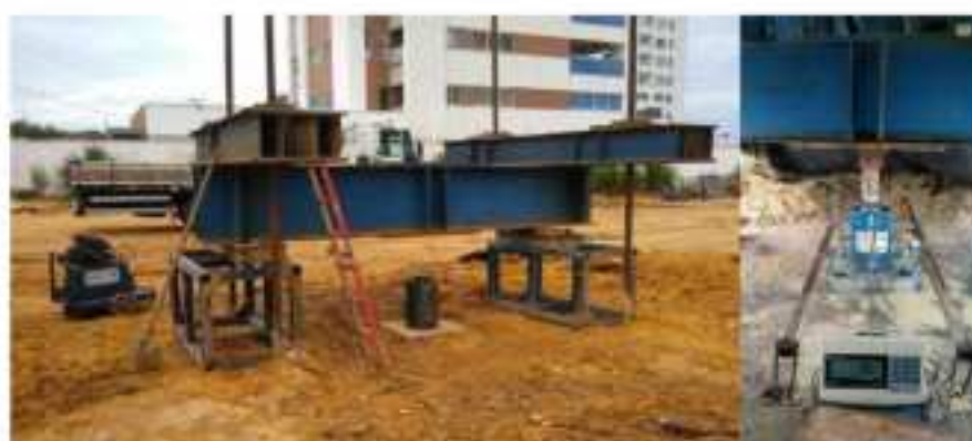
Figura 2 – Montagem do sistema de reação, aplicação de carga e medição dos deslocamentos.
