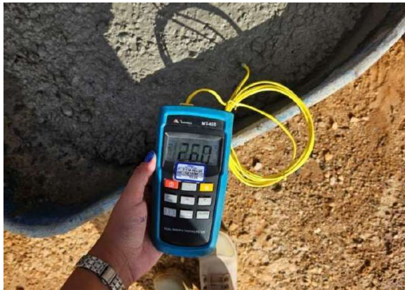
Figura 14: Aferição da temperatura do concreto no recebimento.
