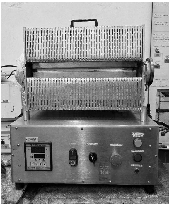
Figura 15 - Reator termoeletrico foi utilizado no processo de pirólise
