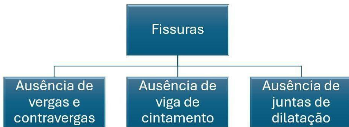
Figura 22 – Manifestações patológicas identificadas na edificação e suas causas - Fissuras
