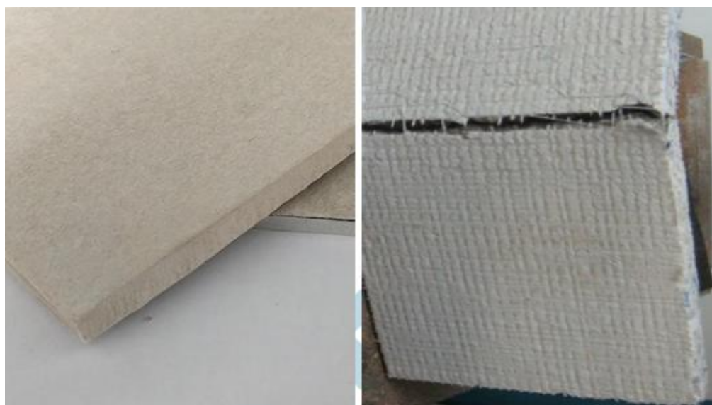
Figura 86 - Placa fibrocimento com fibras dispersas na matriz cimentícia e placa com malha de fibra de vidro
