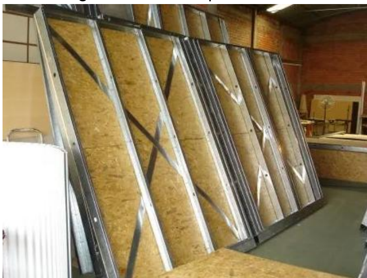
Figura 17 - Painéis pré fabricados
