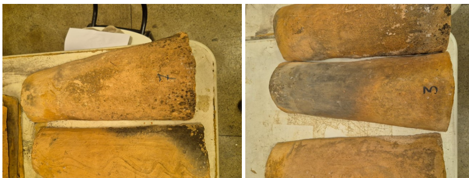
Fotografia 2 e Fotografia 3 - Ensaio de inspeção visual imóveis 1(a) e 2(b)
