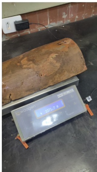
Fotografia 6 - Ensaio de absorção de água, massa seca
