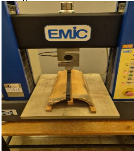
Fotografia 1 - Ensaio de retilineidade
