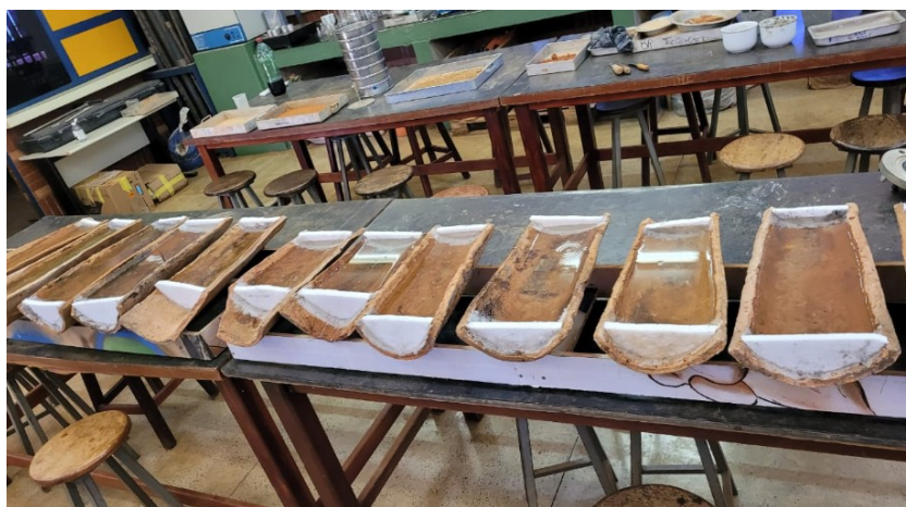
Fotografia 10 - Ensaio de impermeabilidade, molduras preenchidas com água
