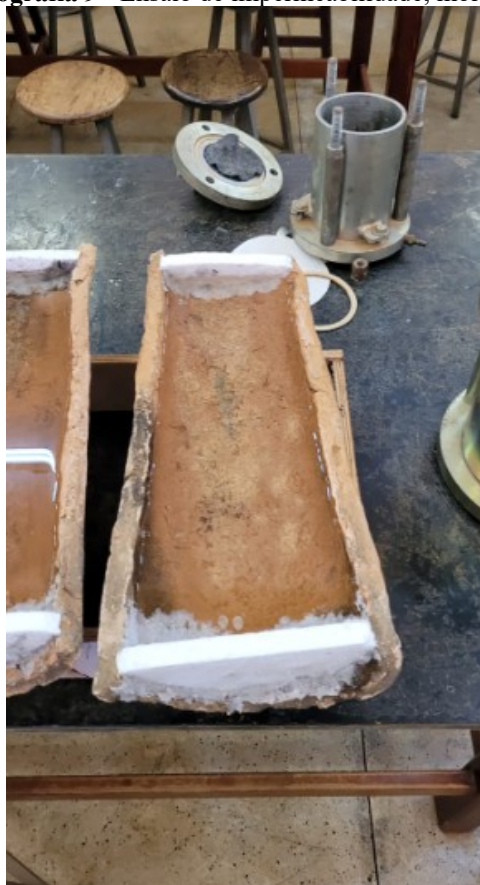
Fotografia 9 - Ensaio de impermeabilidade, molduras
