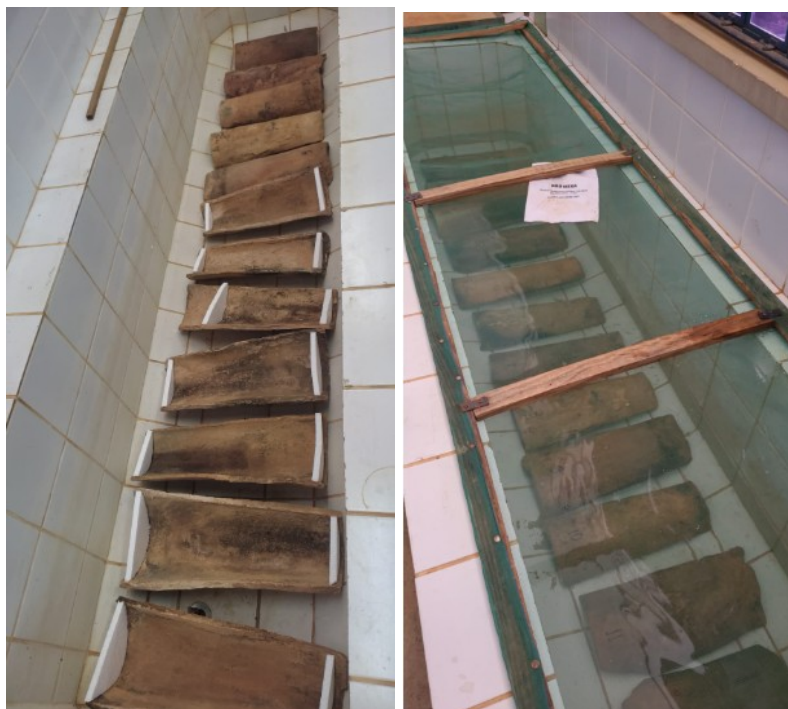
Fotografia 7 e Fotografia 8 - Ensaio de absorção de água, massa úmida
