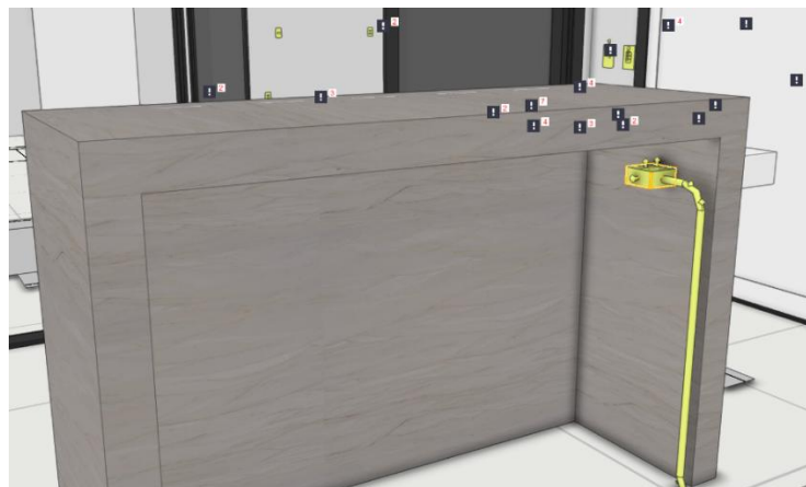
Figura 24 – Ponto de torre de tomadas para bancada fora da parede da ilha da varanda gourmet e com erro na altura.
