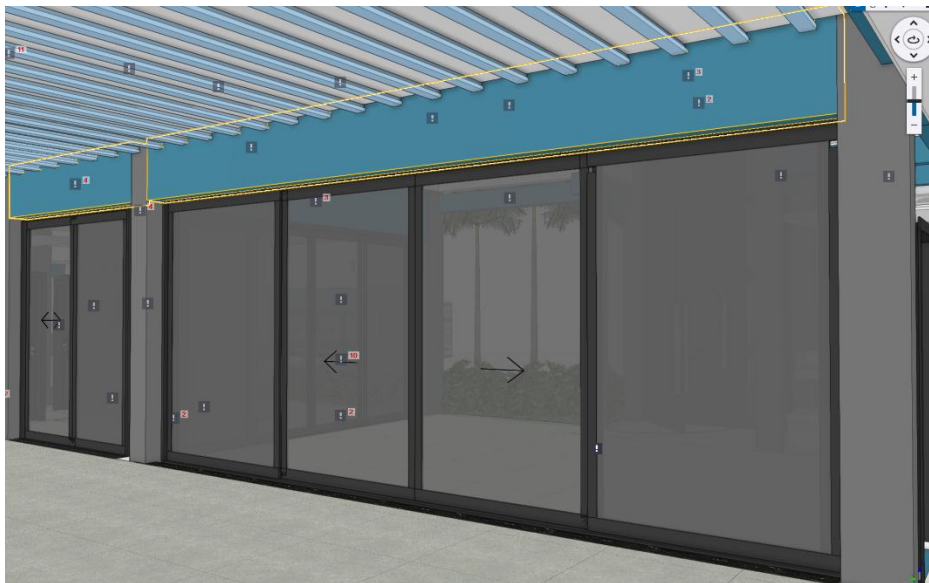
Figura 19 – Viga em conflito com painel de esquadrias
