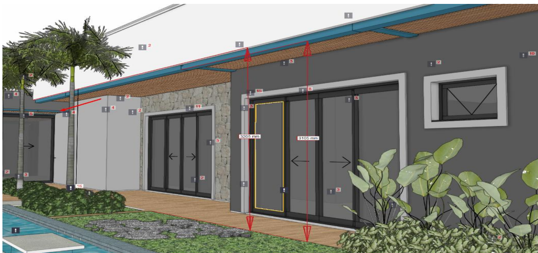
Figura 18 – Vigas expostas ultrapassando o pé-direito e forro
