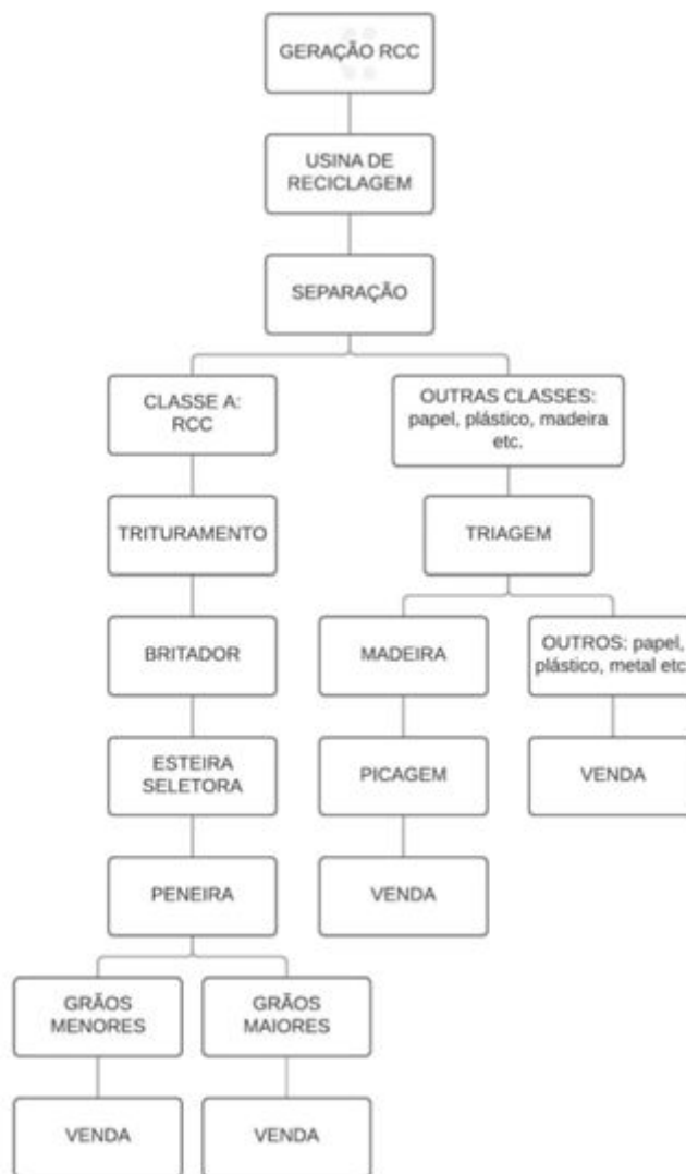
Figura 2: Processo de produção da usina de reciclagem
