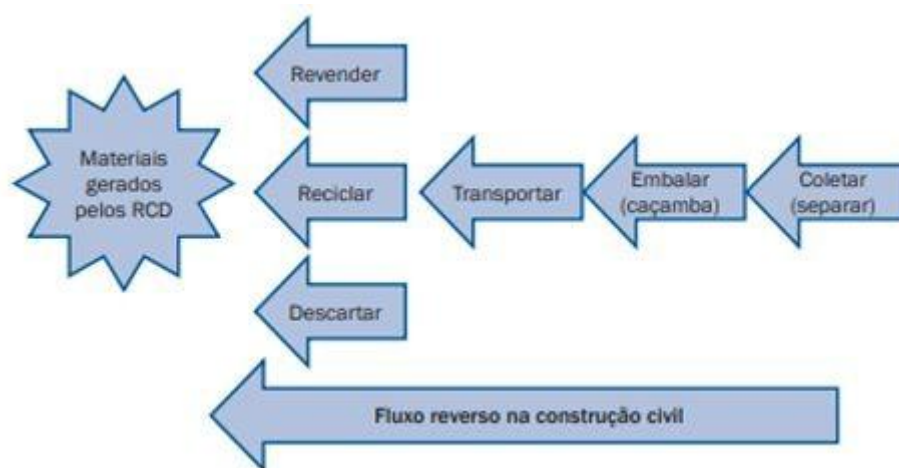
Figura 1: Fluxo logístico reverso na construção civil
