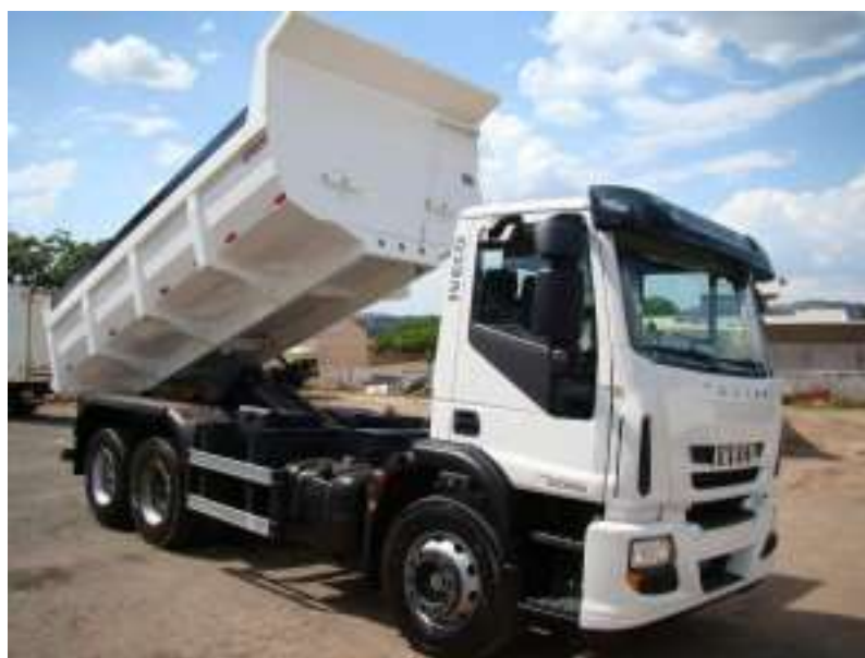
Figura 39 - Caminhões basculante para distribuição do concreto
