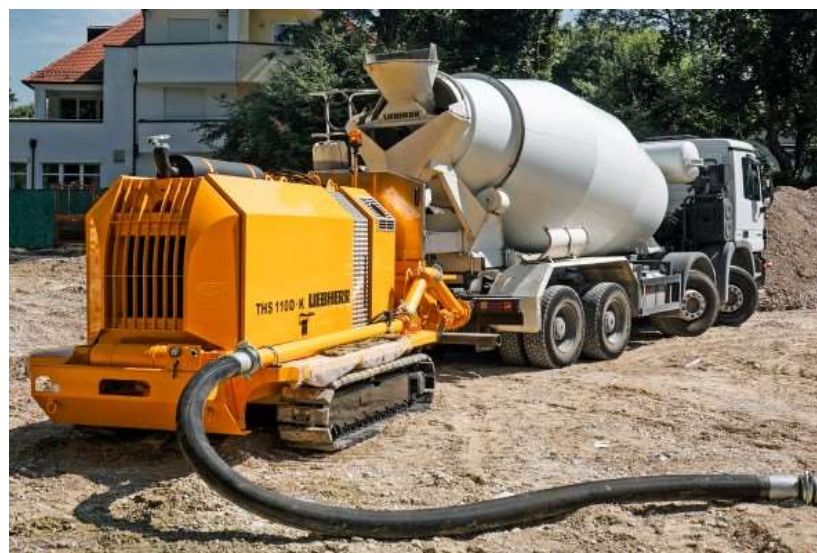
Figura 92 - Bomba de concreto estacionária
