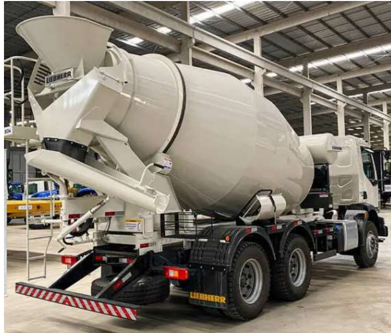
Figura 40 - Caminhões betoneira para distribuição do concreto
