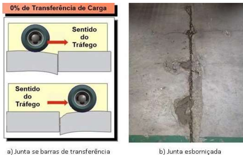
Figura 85 - Representação de juntas transversais sem barras de transferência de cargas
