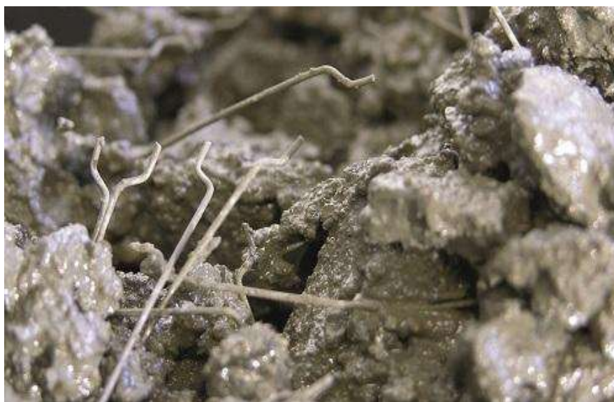
Figura 24 - Concreto com adição de fibras de aço
