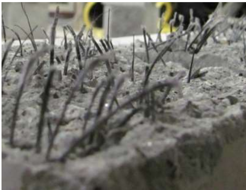
Figura 25 - Concreto reforçado com fibras de aço em seu estado endurecido
