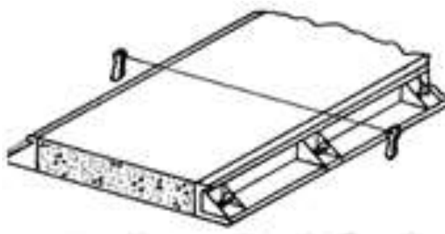
Figura 83 - Marcação do local da futura junta serrada, por pontos fixados
