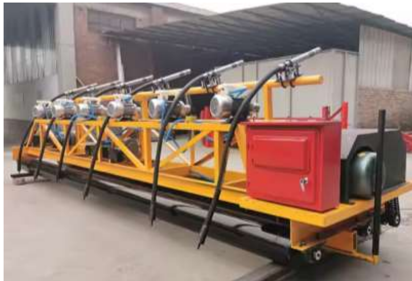
Figura 35 - Pavimentadora de rolo vibratório
