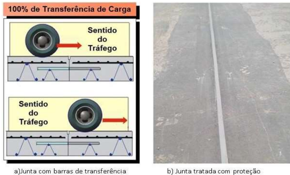
Figura 86 - Representação de juntas transversais com barras de transferência de cargas
