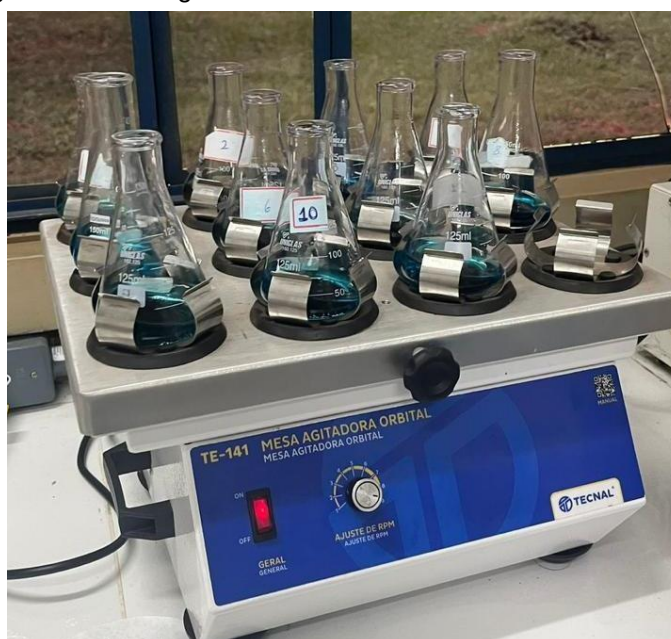
Figura 7 - Mesa agitadora orbital tecnal modelo “Shaker TE 141”.
