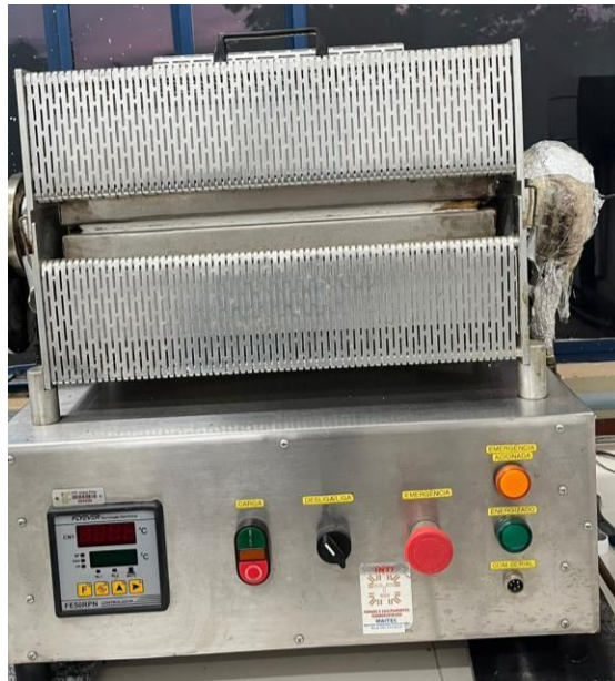
Figura 5: Reator de leito utilizado no ensaio de pirólise.
