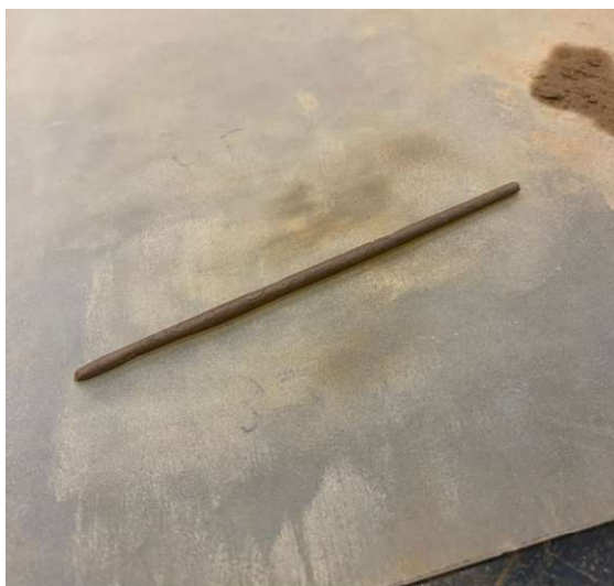
Figura 15 – Cilindro moldado para ensaio de plasticidade.
