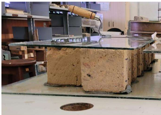
Figura 9 – Capeamento dos Corpos de Prova
