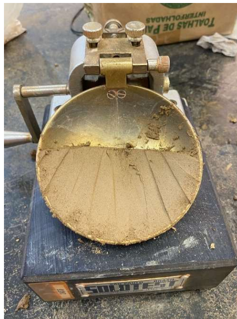
Figura 14 – Pasta moldada no Aparelho de Casagrande.
