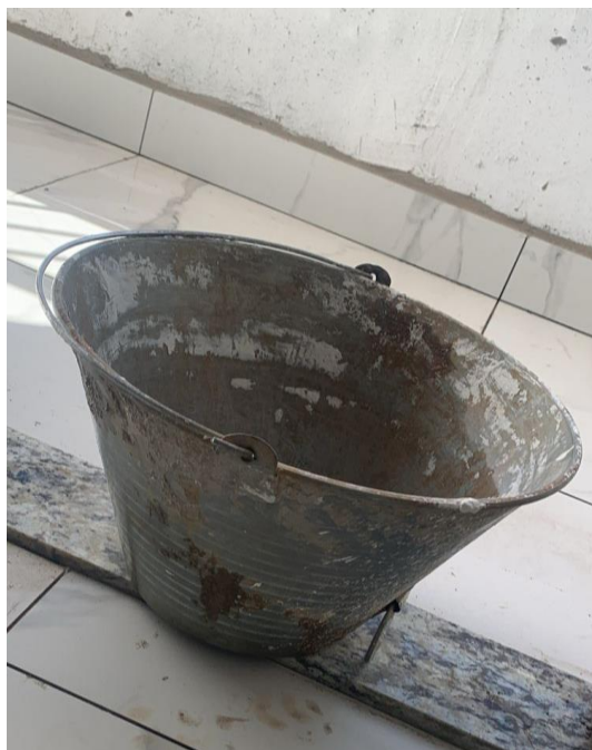
Figura 8 - Balde utilizado com água para verificação de caimento.
