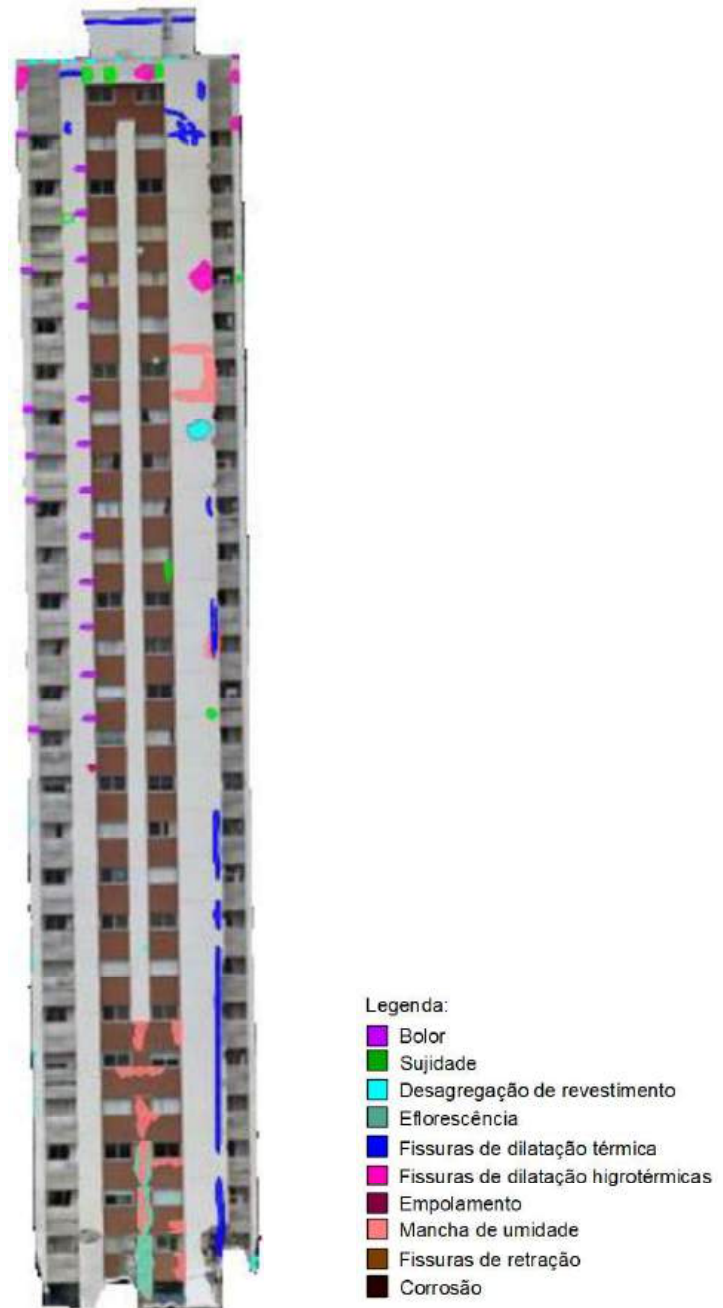
Figura 46 – Mapeamento das manifestações patológicas incidentes na fachada leste do Edifício B, com auxílio do Auto-Cad
