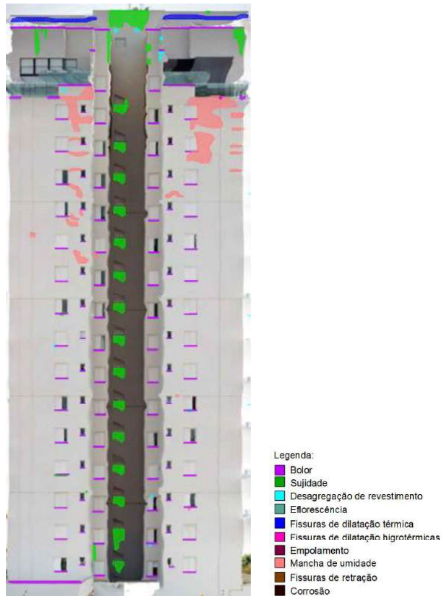
Figura 51 – Mapeamento das manifestações patológicas incidentes na fachada leste do Edifício C, com auxílio do Auto-Cad
