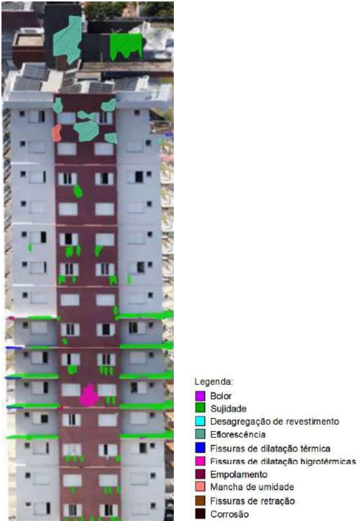
Figura 55 – Mapeamento das manifestações patológicas incidentes na fachada oeste do Edifício D, com auxílio do Auto-Cad
