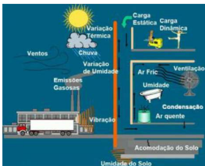
Figura 2 – Condições de exposição de uma edificação
