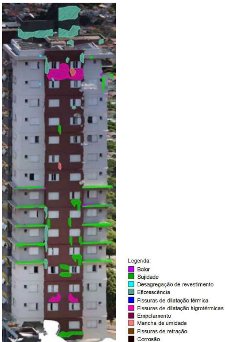
Figura 54 – Mapeamento das manifestações patológicas incidentes na fachada leste do Edifício D, com auxílio do Auto-Cad
