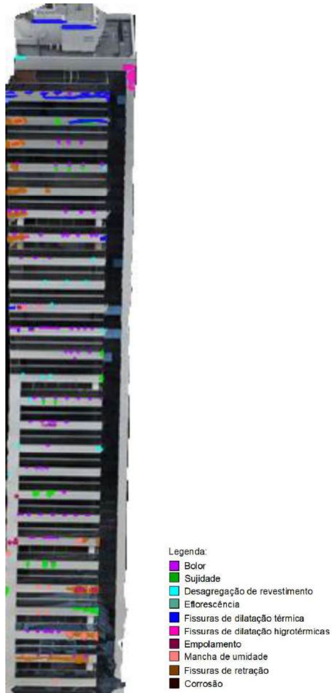
Figura 45 – Mapeamento das manifestações patológicas na fachada oeste do Edifício B, com auxílio do Auto-Cad
