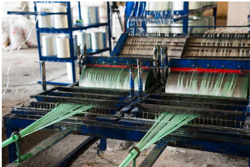
Figura 14 – Fabricação de fios de fibra de vidro.
