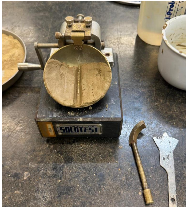
Figura 25 – Sulco central na amostra feita com o cinzel
