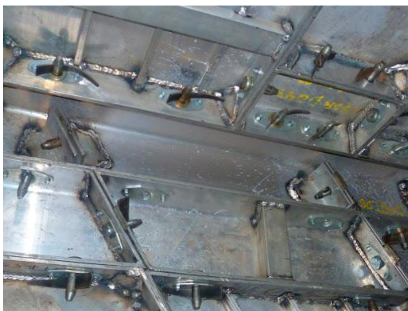
Figura 2 – Acessórios de travamento: faquetas, pinos e cunhas
