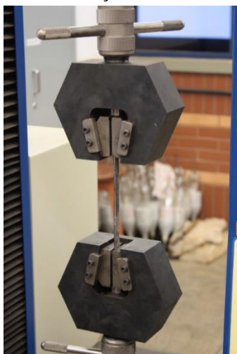
Figura 114 – Ensaio de tração realizado com amostras de aço retirado da estrutura
