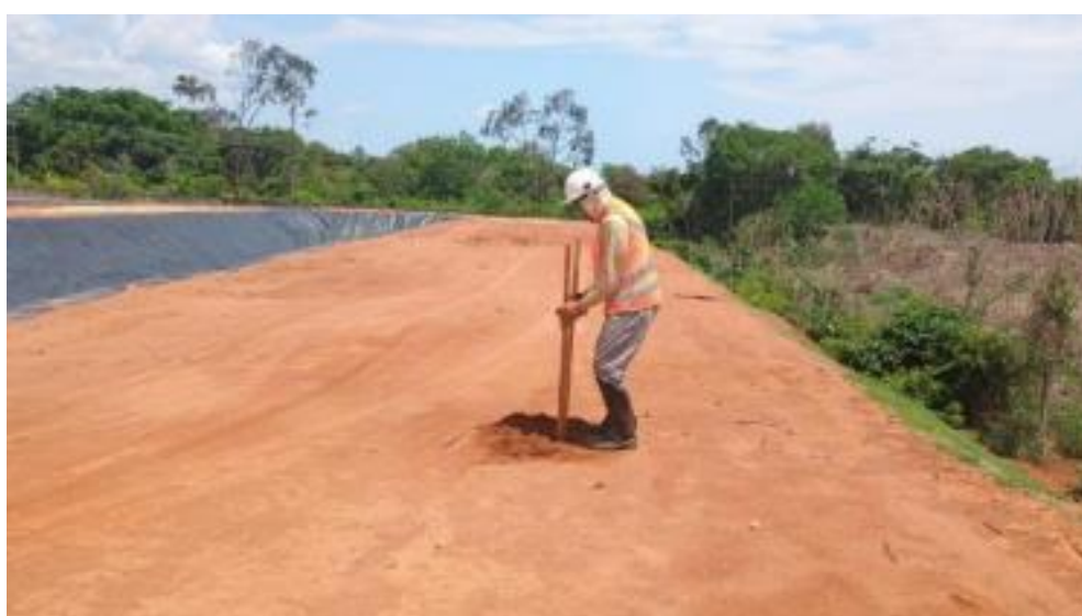
Figura 2.2 - Retirada de amostra deformada
