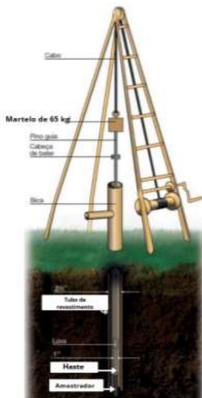
Figura 03 - Equipamento utilizado para execução de sondagem à percussão
