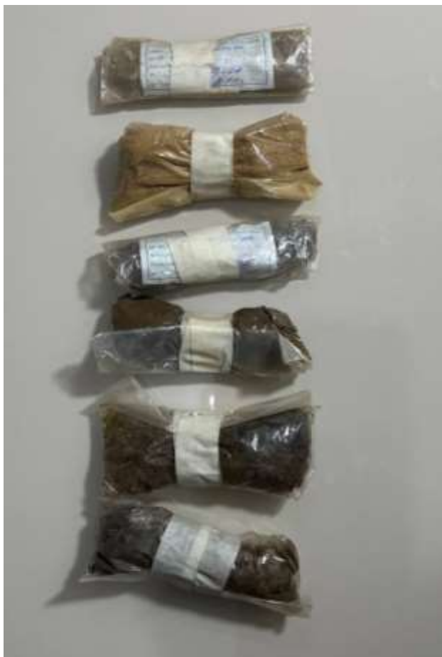
Figura 14 - Amostras representativas obtidas por sondagem SPT
