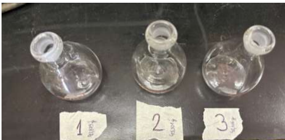
Figura 10 - Picnômetros utilizados para ensaio densidade real do solo
