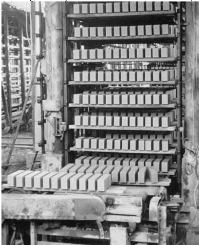
Figura 8 - Secagem de tijolos crus ao ar livre numa olaria, Alemanha
