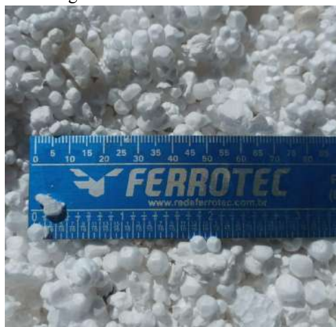
Figura 3 - Granulometria do EPS
