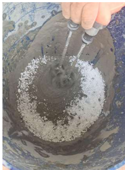
Figura 10 - EPS adicionado na argamassa cimentícia (traço 30%)
