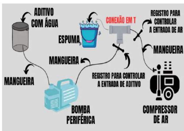
Figura 5 - Desenho esquemático componentes do gerador de espuma
