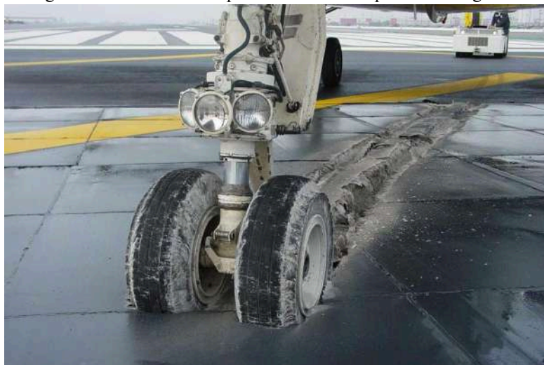
Figura 1 - Sistema de escape utilizado no aeroporto de Congonhas
