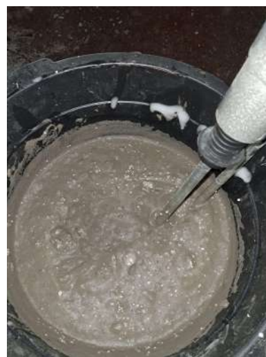
Figura 14 - Concreto celular final com EPS (traço 30%)
