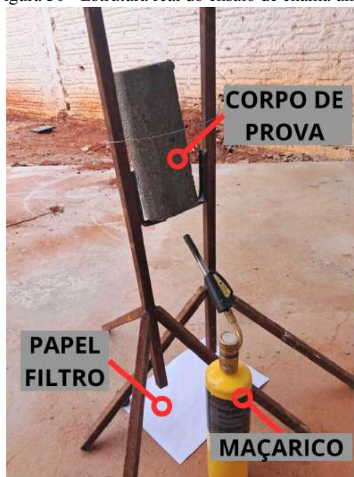
Figura 30 - Estrutura real do ensaio de chama única
