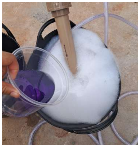
Figura 11 - Aditivo Espumígeno sendo preparado
