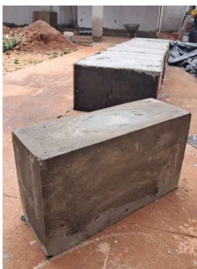
Figura 18 - Bloco de concreto celular pronto (traço referência)
