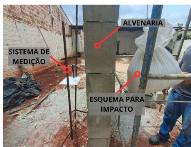
Figura 27 -Esquema completo utilizado para aplicação dos impactos e leitura dos deslocamentos
