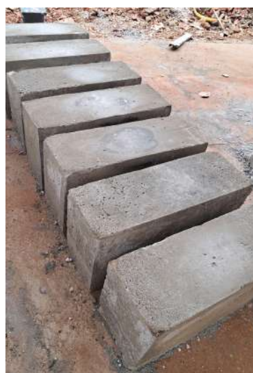
Figura 19 - Bloco de concreto celular pronto (traço 30%)
