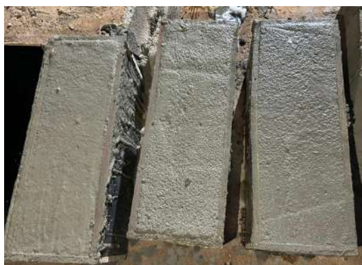
Figura 17 - Blocos de concreto celular moldados
