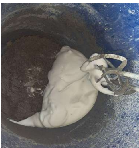
Figura 13 - Mistura da espuma na argamassa (traço 30%)
