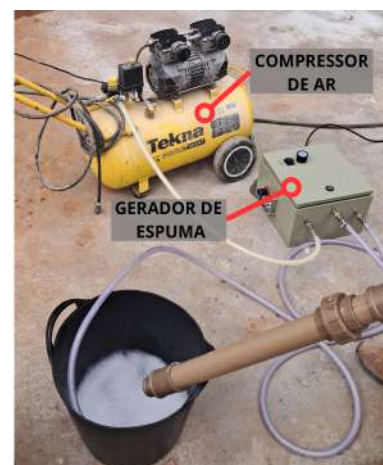
Figura 6 - Sistema gerador de espuma
