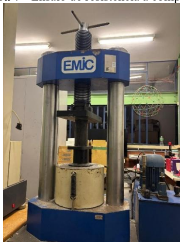
Figura 7 - Ensaio de resistência à compressão
