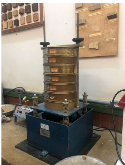
Figura 4 – Análise granulométrica dos agregados
