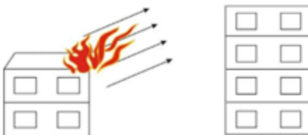
Figura 3 – Propagação entre cobertura e fachada
