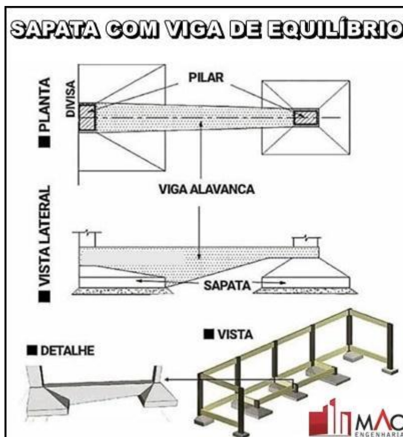
Figura 4 – Sapata alavancada ou com viga de equilíbrio
