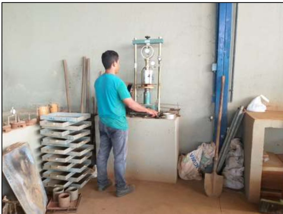
Figura 39. Ensaio de CBR
