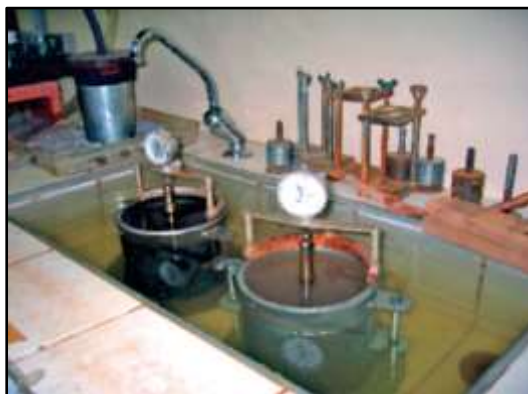
Figura 15. Imersão dos corpos-de-prova em água para medida de expansão axial
