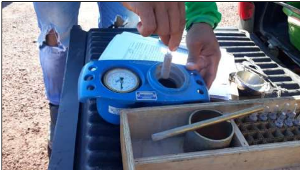
Figura 36. Ensaio de umidade natural com auxílio do speedy test
