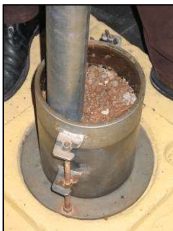
Figura 14. Compactação de corpos-de-prova
