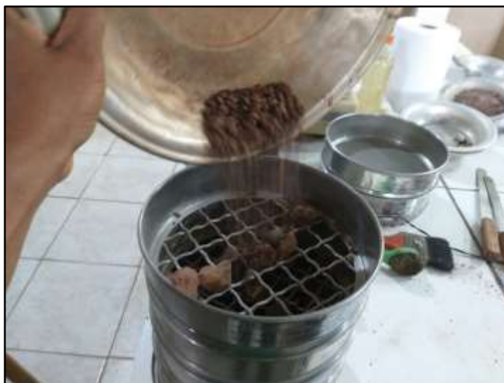
Figura 24. Realização do ensaio de granulometria por peneiramento a seco
