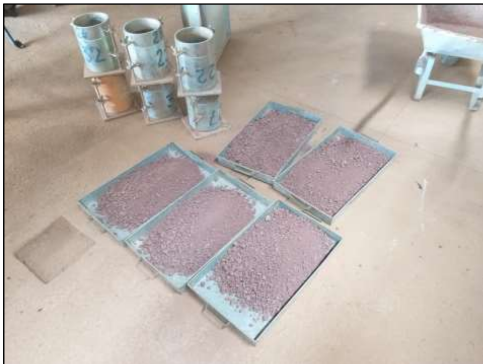
Figura 37. Ensaio de compactação normal de Proctor
