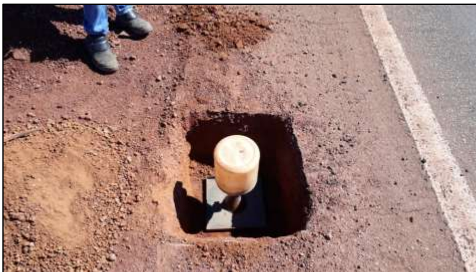
Figura 35. Ensaio da massa específica in situ com emprego do frasco de areia
