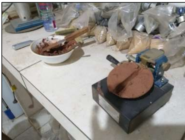
Figura 31. Realização do ensaio de Casagrande para a determinação do limite de liquidez
