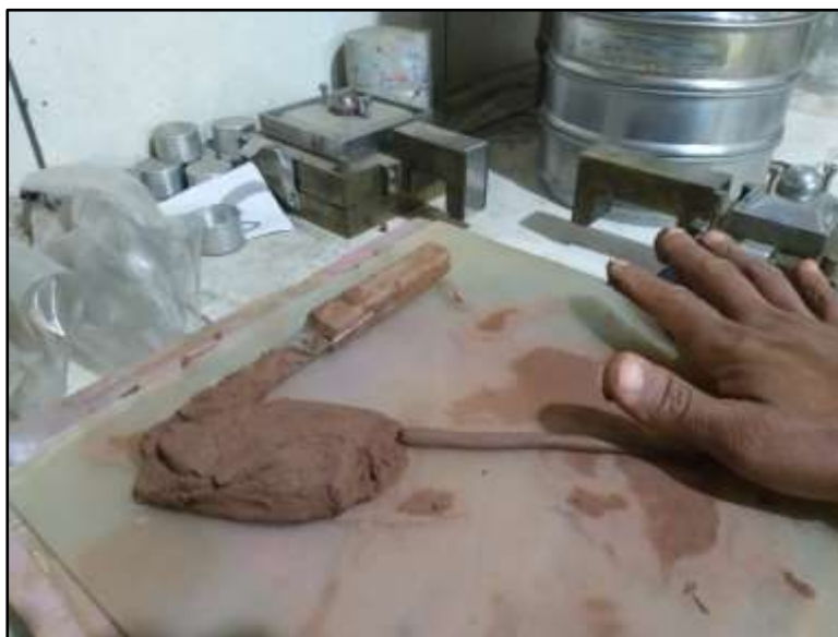
Figura 32. Ensaio de limite de plasticidade
