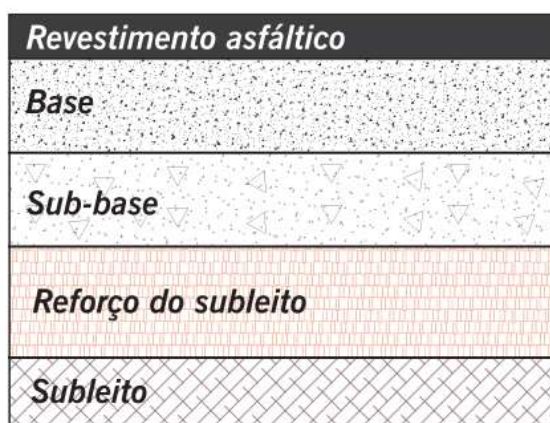
Figura 1. Estrutura de Pavimento Flexível
