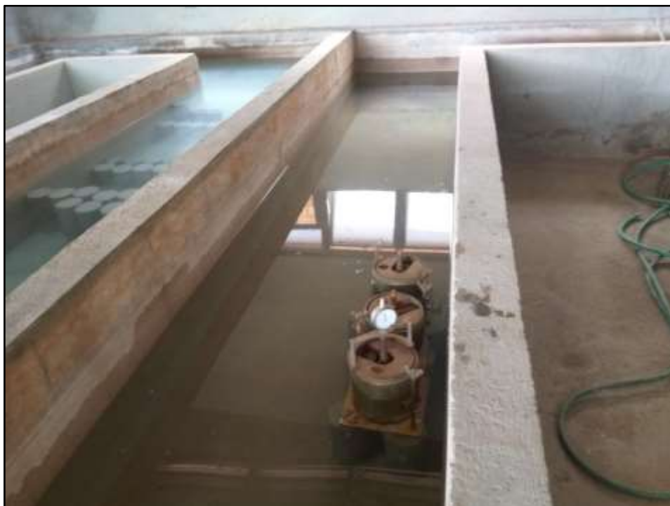
Figura 38. Ensaio de expansibilidade
