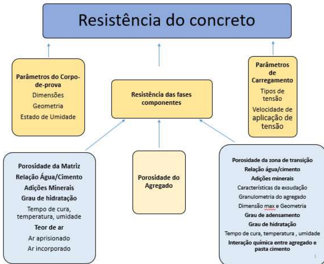
Figura 6 - Fluxograma da interação dos fatores que influenciam na resistência do concreto
