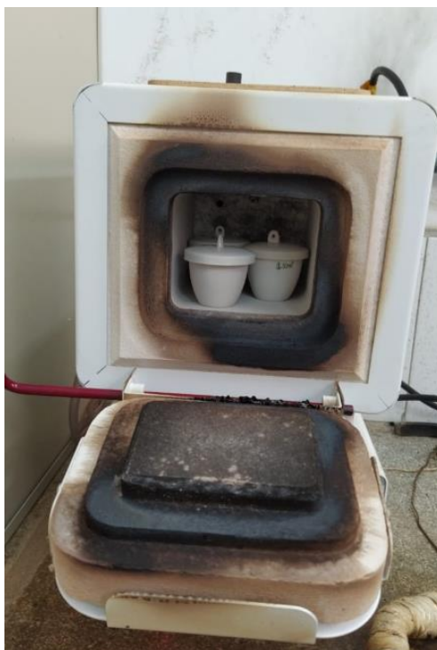
Figura 17: Mufla, cadinhos e biomassa pronta para iniciar a pirólise a 500 °C
