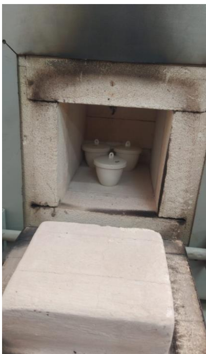
Figura 09: Mufla com cadinhos prontos para ensaio de material volátil
