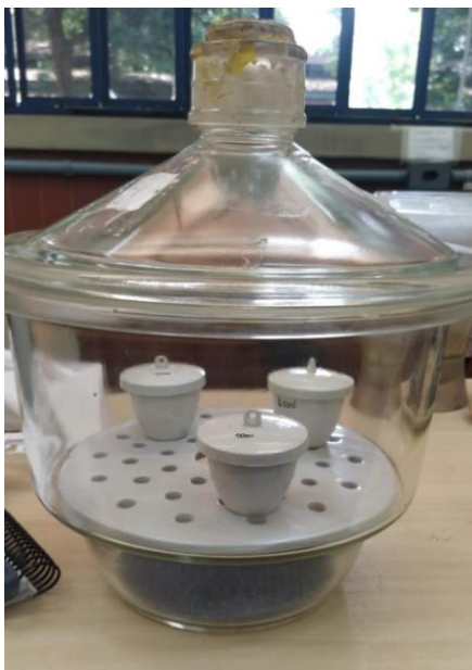
Figura 10: Dessecador com as amostras para a determinação do material volátil
