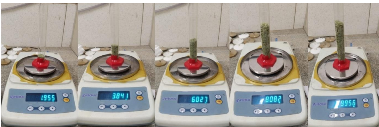
Figura 07: Ensaios de densidade aparente da biomassa, amostras com volume de 10, 20, 30, 40 e 50 mL, respectivamente.
