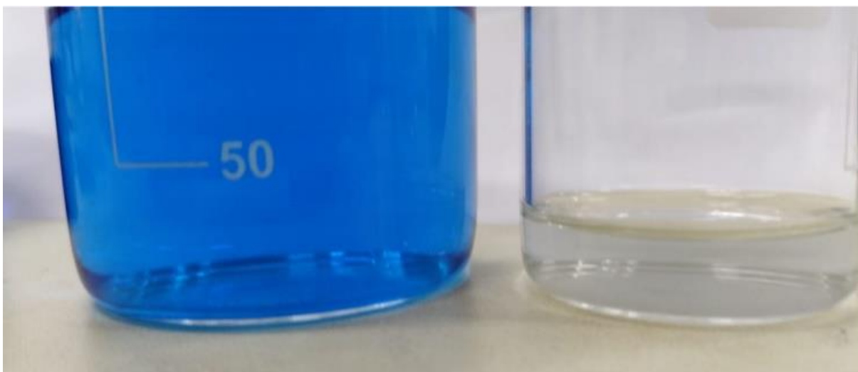
Figura 35: Concentração de azul metileno antes e após a realização do ensaio 6.
