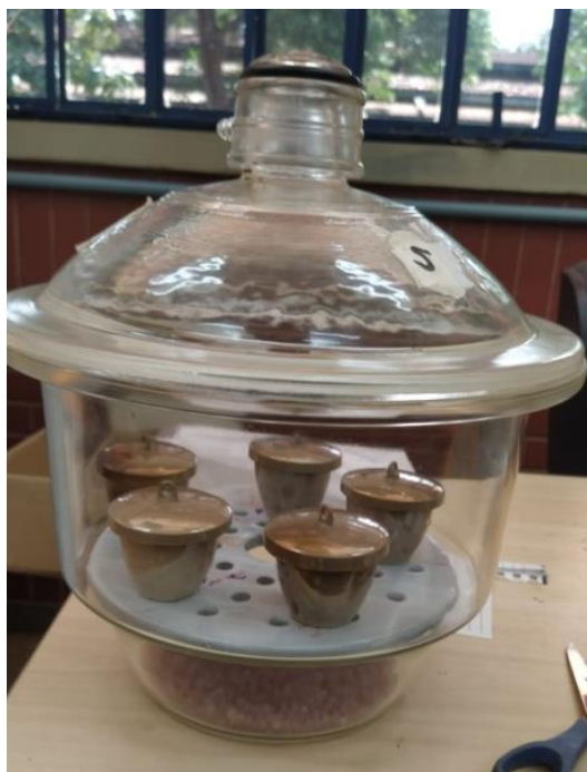
Figura 20: Dessecador com as amostras do carvão ativado a 300 °C
