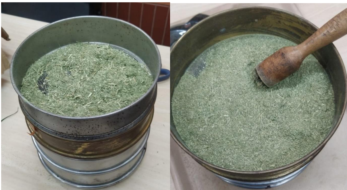
Figura 06: Material retido nas peneiras de 14 e 325 Mesh, respectivamente
