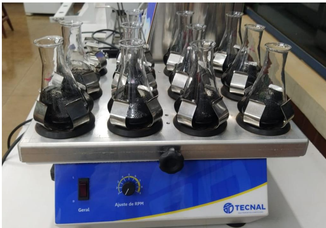
Figura 26: Amostras prontas para iniciar agitação orbital horizontal
