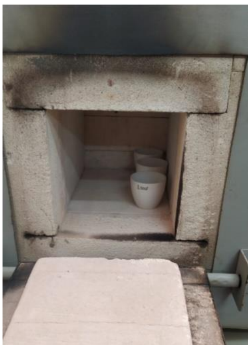
Figura 12: Mufla com cadinhos prontos para ensaio de teor de cinzas
