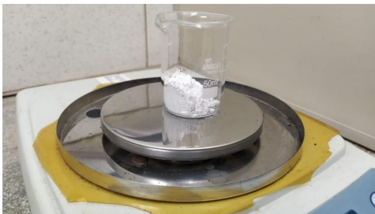
Figura 15: Dosagem de 5% (m/m) a ser adicionado a biomassa.
