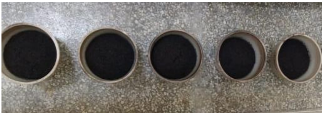
Figura 21: Carvão ativado produzido em mufla a 300°C
