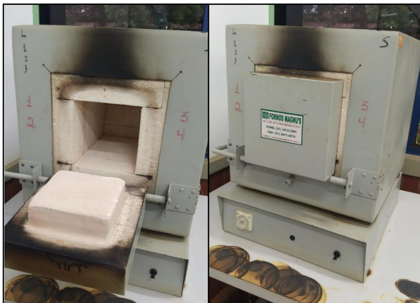
Figura 08: Mufla a ser utilizada para a obtenção do material volátil
