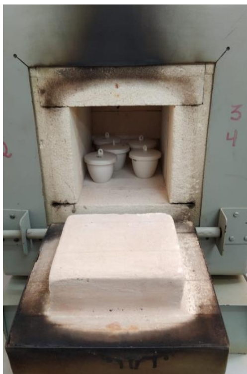
Figura 18: Mufla, cadinhos e biomassa pronta para iniciar a pirólise a 300 °C
