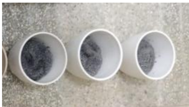
Figura 22: Carvão ativado produzido em mufla a 500°C
