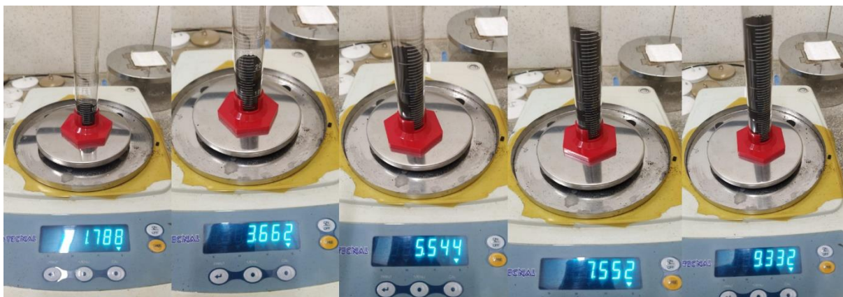
Figura 23: Ensaios de densidade aparente do carvão ativado, amostras com volume de 10, 20, 30, 40 e 50 mL, respectivamente.
