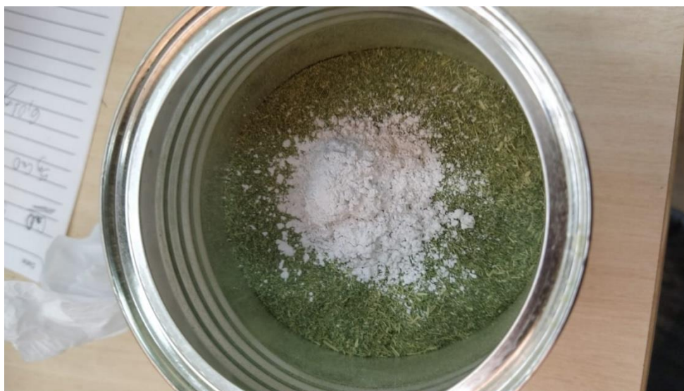
Figura 16: Catalisador e biomassa prontos para homogeneização e posteriormente serem pirolizadas.
