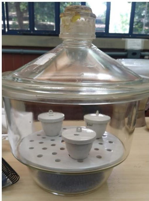
Figura 19: Dessecador com as amostras do carvão ativado a 500 °C
