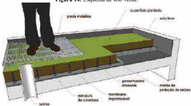
Figura 14: Esquema de teto verde.
