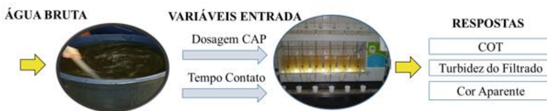
Figura 2 - Planejamento experimental do DFC para o estudo das condições de aplicação dos CAPs.
