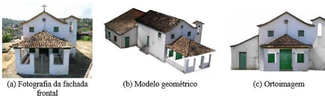
Figura 17 - Comparações entre fotografia tirada da fachada de edifício, modelo geométrico formado e ortoimagem
