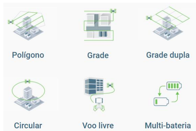
Figura 19 - Formas de planejamento de voo com o Pix4DCapture
