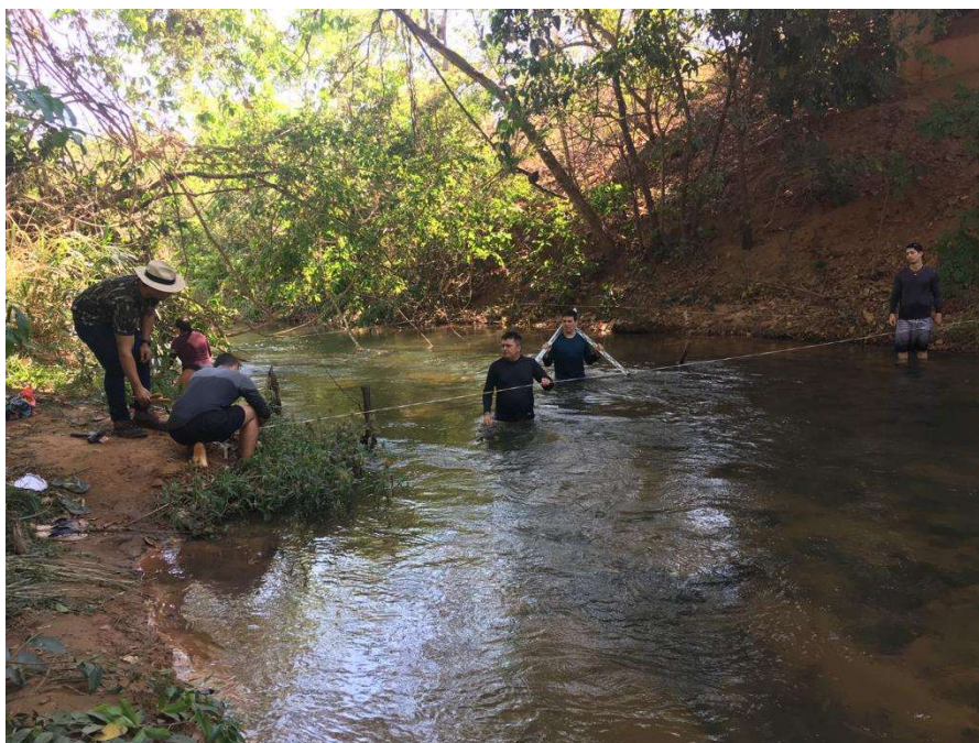
Figura 11 - Aplicação da metodologia do flutuador no Ribeirão do Abreu
