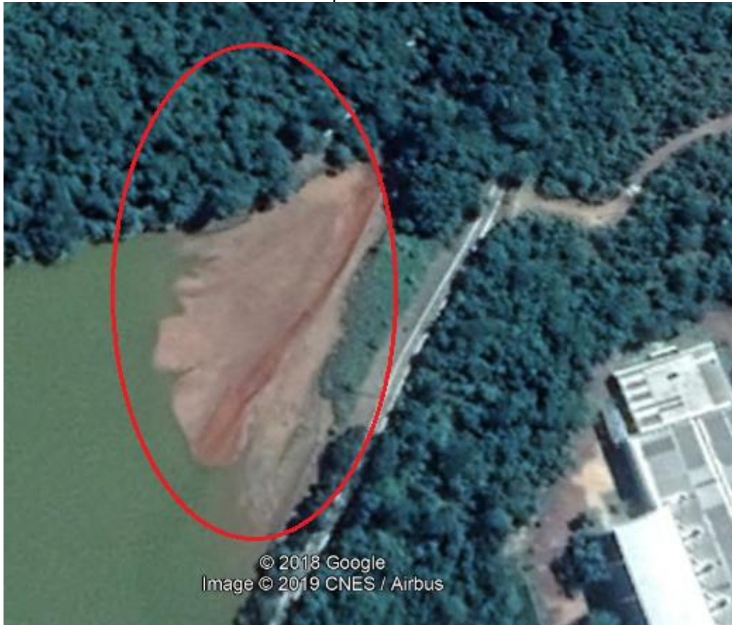
Figura 12 - Assoreamento no Lago do Parque Cesamar resultante do transporte dos sedimentos causados pela erosão hídrica
