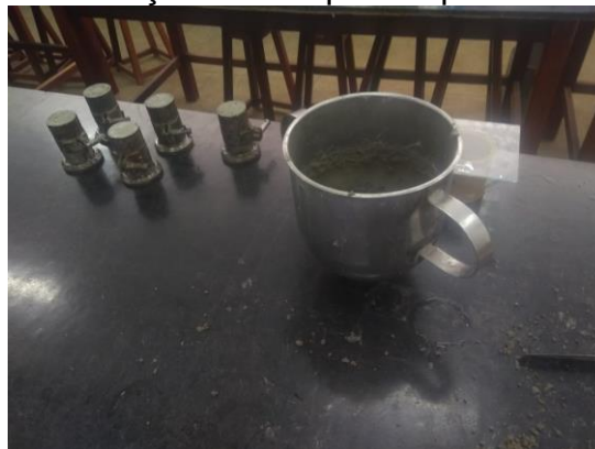
Figura 11 - Confeccção dos corpos de prova de argamassa
