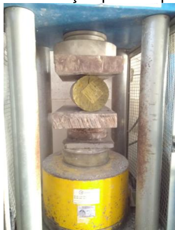
Figura 16 - Ensaio de tração por compressão diametral
