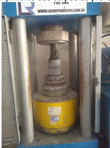
Figura 12 - Rompimento dos corpos de prova de argamassa
