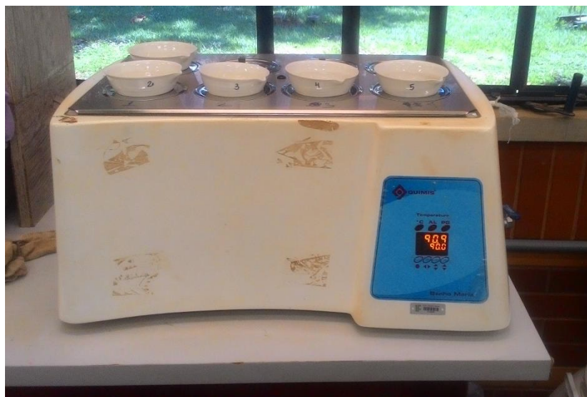
Figura 16 - Ensaio para determinação de sólidos suspensos totais Fonte: Autor (2019)
