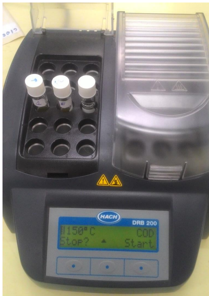
Figura 18 - Ensaio para determinação de demanda química de oxigênio (DQO) Fonte: Autor (2019)
