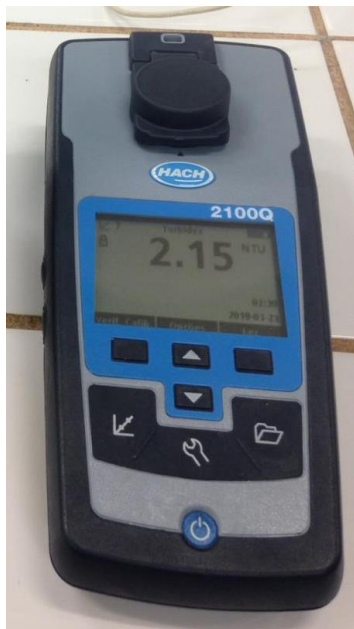
Figura 17 - Ensaio para determinação de turbidez. Fonte: Autor (2019)
