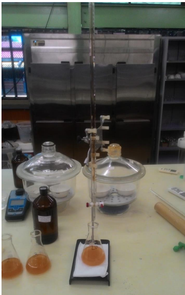
Figura 19 - Ensaio para determinação de cloretos Fonte: Autor (2019)
