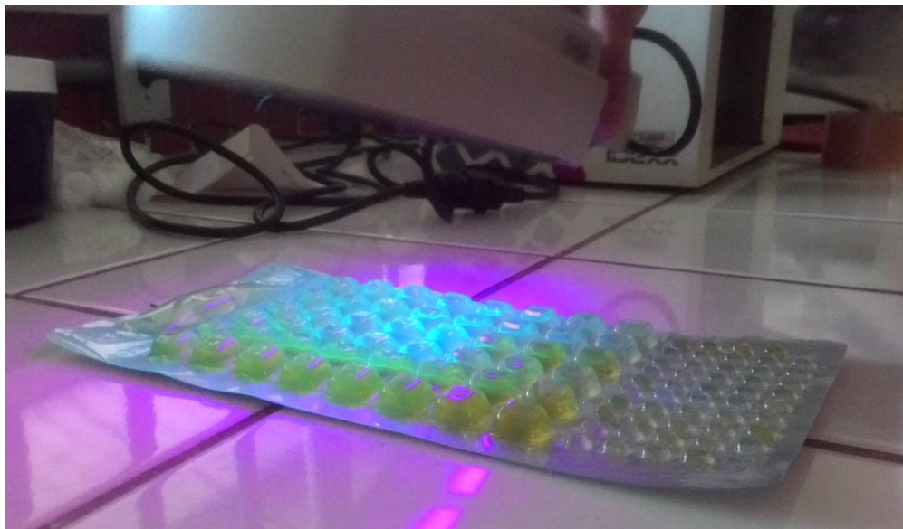
Figura 20 - Ensaio para determinação de coliformes fecais e Escherichia coli Fonte: Autor (2019)
