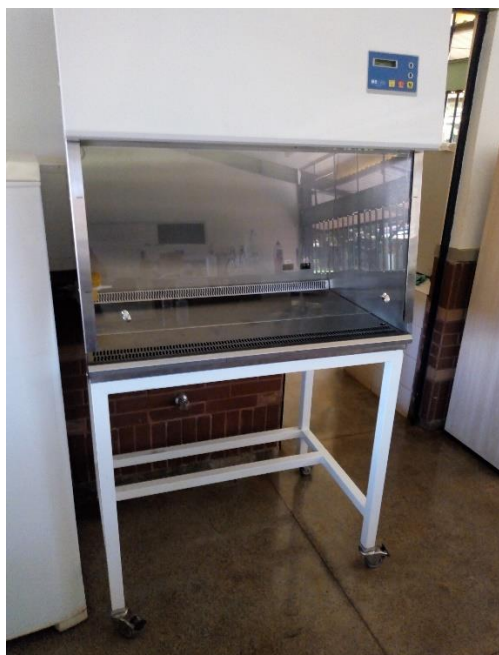
Figura 6.4 – Câmara de fluxo laminar empregada na realização dos ensaios bacteriológicos
