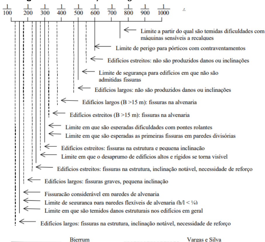
Figura 26 – Distorções angulares e danos associados.
