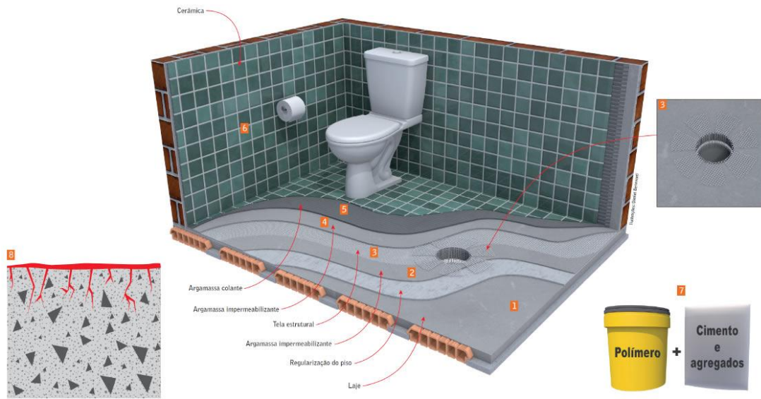
Figura 39 - Impermeabilização com argamassa polimérica em Paredes de Concreto
