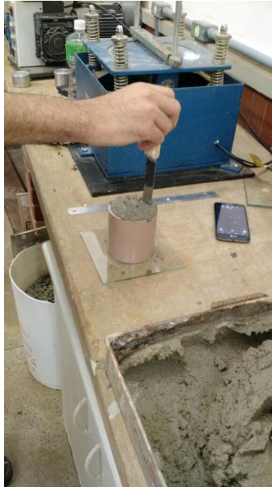
Figura 6 – Aplicação de golpes para adensamento
