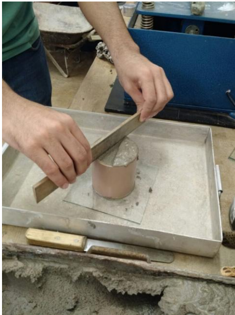
Figura 8 – Rasamento da superfície da argamassa
