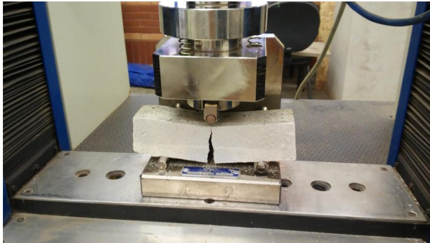
Figura 17 – Ensaio de resistência à flexão
