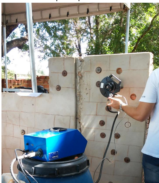
Figura 15 – Ensaio de corpo de prova com dinamômetro de tração
