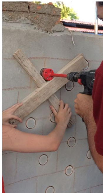
Figura 12 – Procedimento de corte para obtenção de corpos de prova
