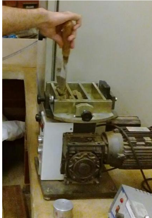
Figura 16 – Argamassa sendo introduzida no molde
