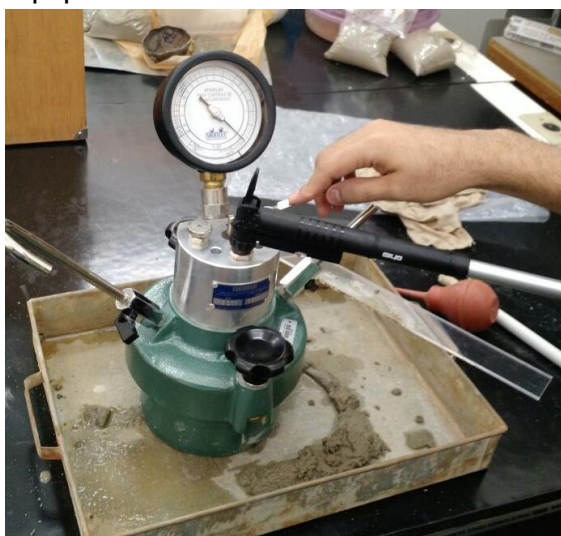
Figura 11 – Equipamento de leitura de teor de ar sendo operado.
