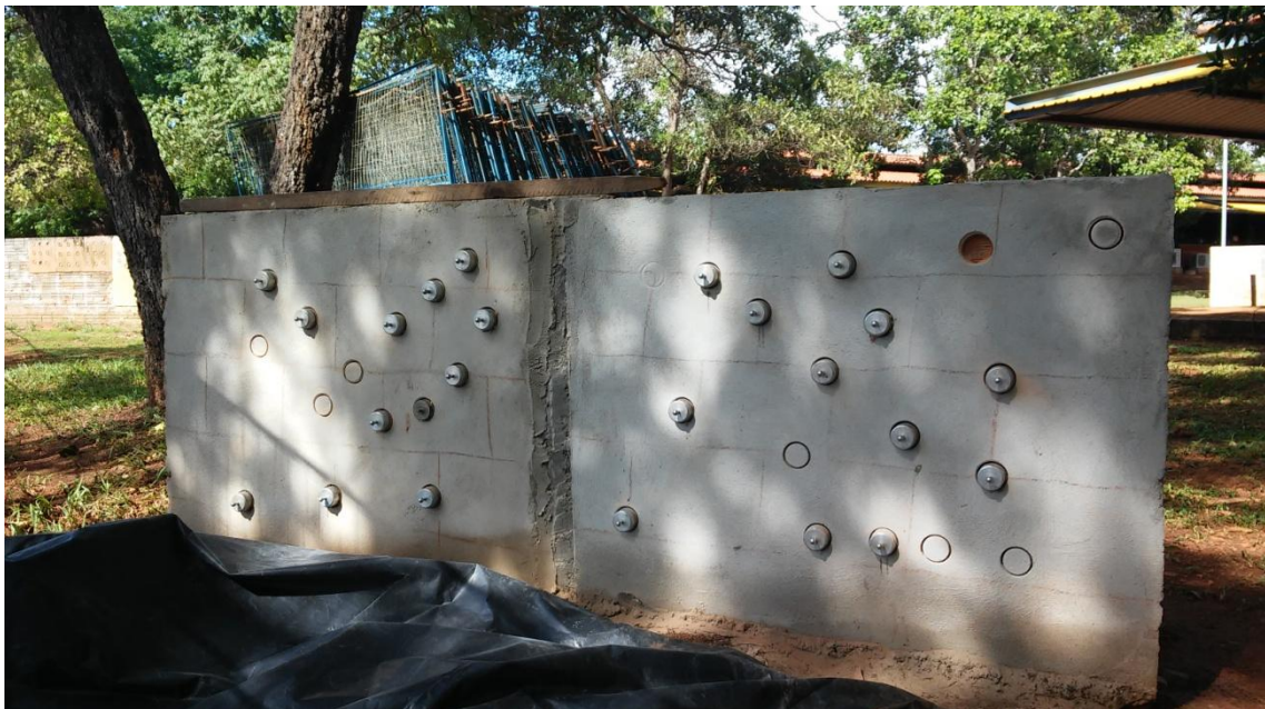
Figura 14 – Pastilhas fixadas nos corpos de prova
