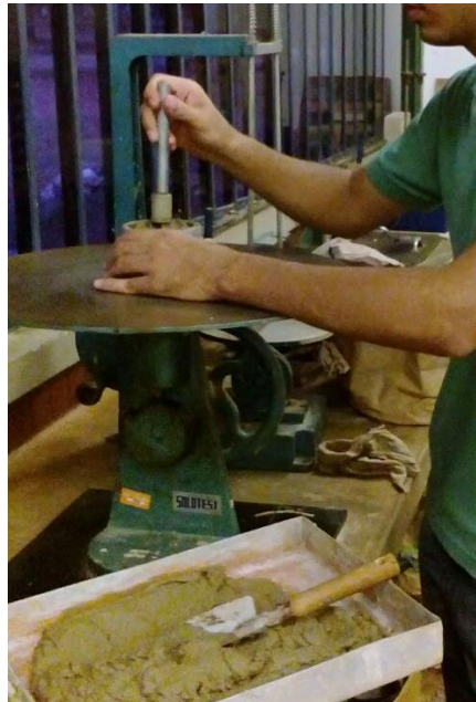
Figura 9 – Adensamento da argamassa por meio da aplicação de golpes
