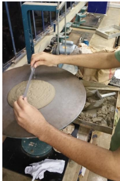
Figura 10 – Medição do diâmetro do espalhamento da argamassa
