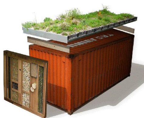
Figura 32 - Detalhe de cobertura verde em possível construção com uso de container
